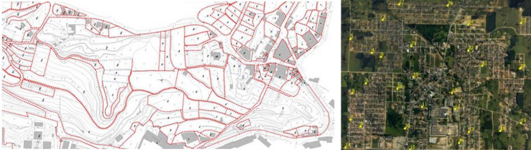
FIGURA 9 - LEVANTAMENTO TOPOGRÁFICO GEORREFERENCIADO E IMAGEM AÉREA COM PONTOS DE CONTROLE.
