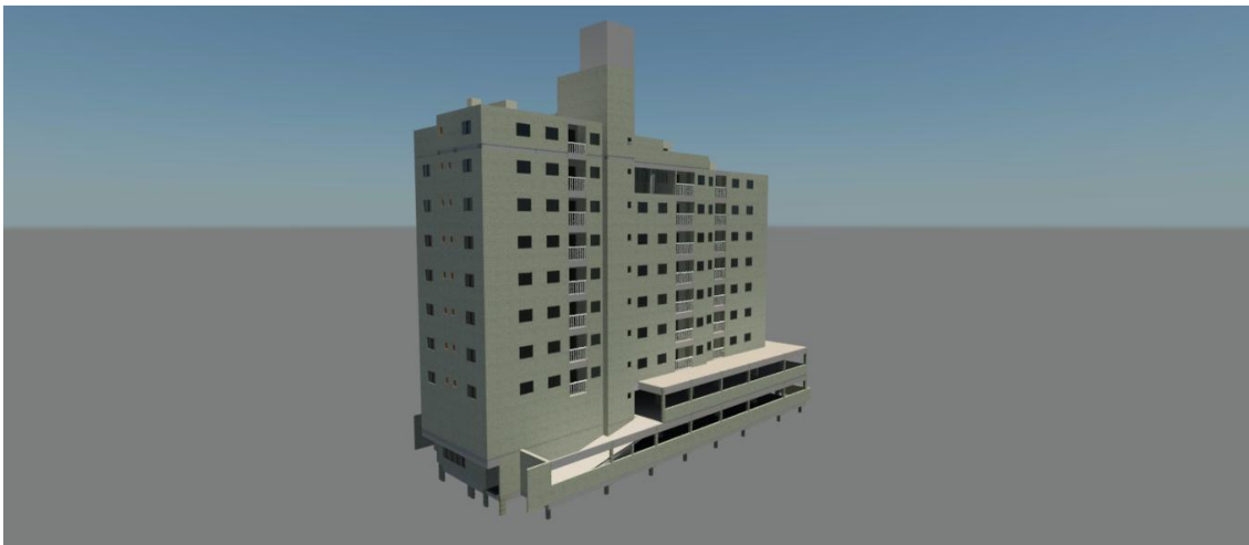
Figura 9 – Projeto Arquitetônico e Estrutural associados no Navisworks
