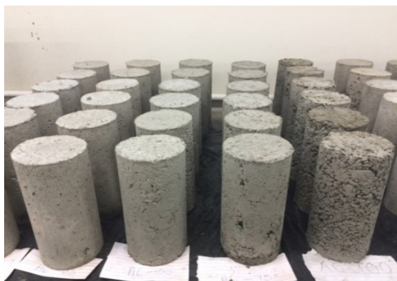
Figura 4 – Concretos obtidos com resíduo têxtil. A) adição de resíduo; B) substituição do cimento pelo resíduo – Criciúma SC.
