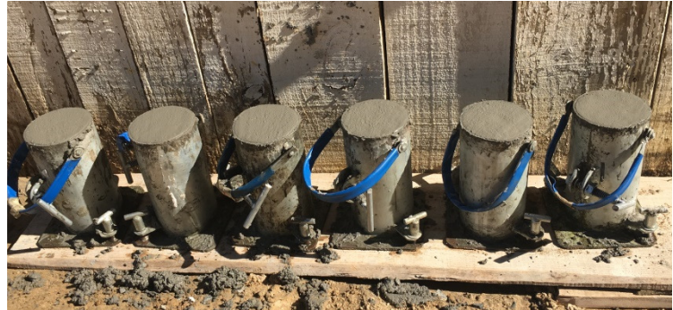
Figura 2b: Detalhe da moldagem dos corpos de prova.
