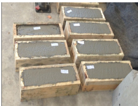
Figura 2- Moldagem do corpo de prova
