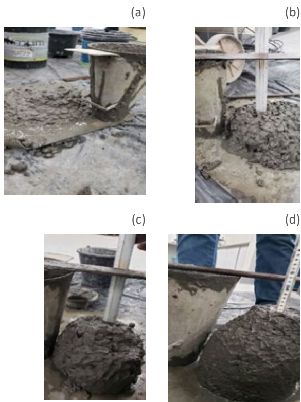
Figura 2. Abatimento obtido para cada teor de substituição: (a) CC0, (b) CC7,5, (c) CC15, (d) CC22,5. (Fonte: elaboração própria)
