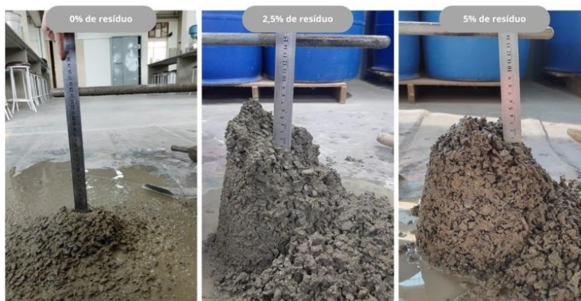
Figura 6. Resultado fotográfico do abatimento de cone
