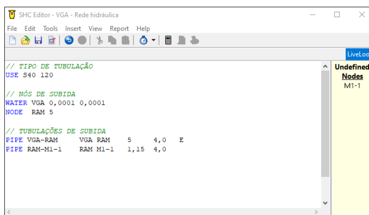
Figura 12. Lançamento trecho a trecho da tubulação de alimentação da rede hidráulica.
