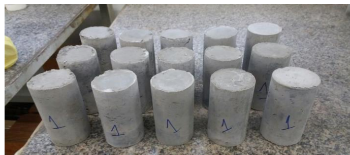
Figura 5 – Corpos de provas desmoldados.
