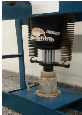
Figura 4 – Aplicação da pressão nos corpos de prova.
