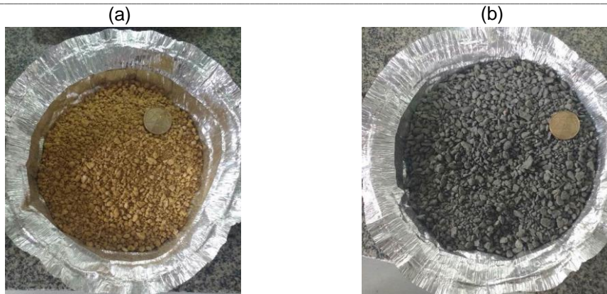
Figura 1. (a) Solo argiloso da formação Palermo; (b) Rejeito de beneficiamento de carvão (RBC).
