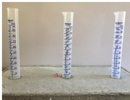
Figura 4 - Provetas fixadas com selantes na placa de concreto.
