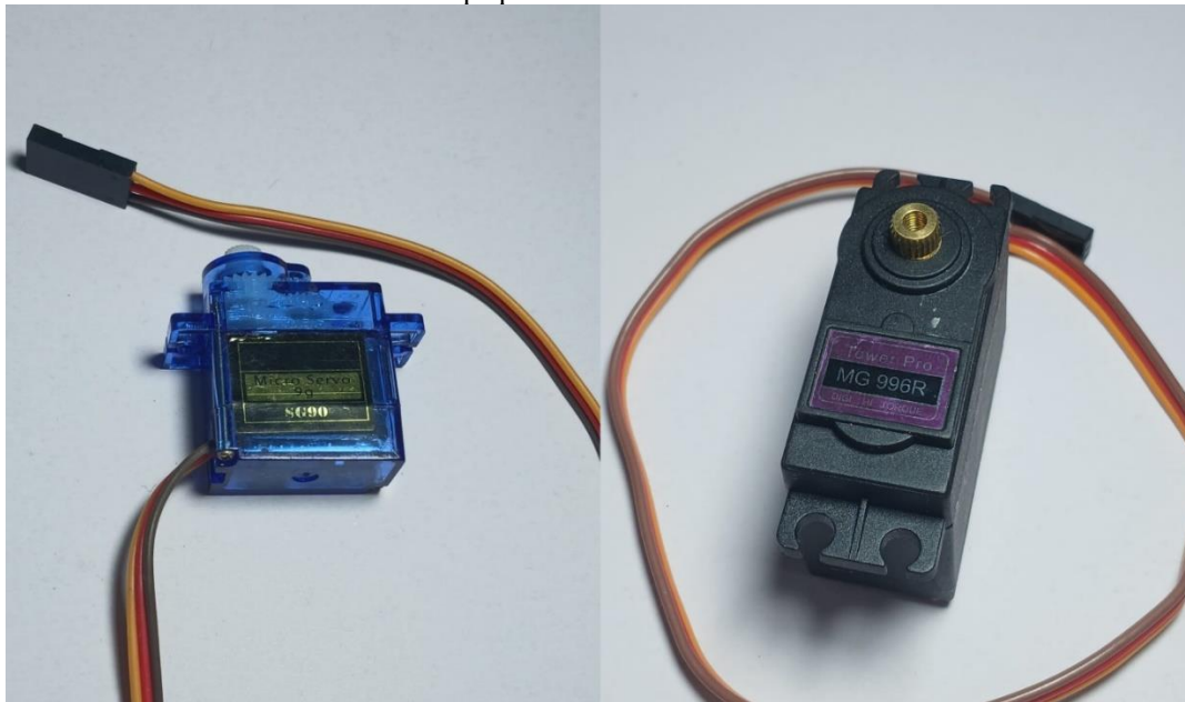
Figura 1: Imagem Micro Servo Motor SG90 e MG996R, componentes utilizados para controle de movimento em pequenos mecanismos.
