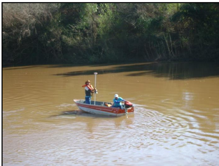
Figura 4. Execução de levantamento de seção topobatimétrico.
